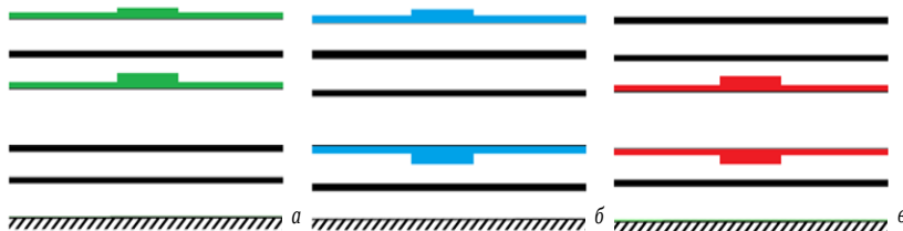
Рисунок 2.48 – Геометрические модели поперечного сечения МПП для вариантов на разных слоях: a , b , v
