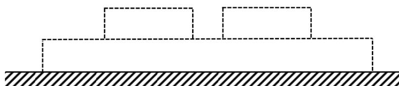
Рисунок 2.7 – Исследуемая конфигурация – два проводника с диэлектриком над идеально проводящей плоскостью
