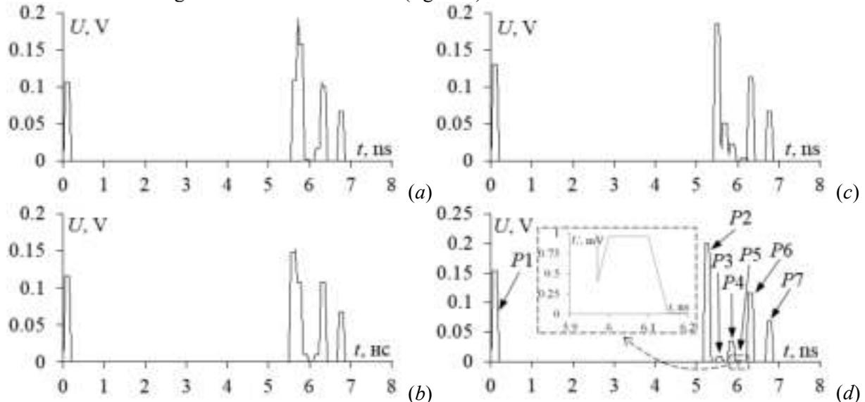
**Figure 3.** Voltage waveform at node  $V4$  with  $s_1=40$  (a), 30 (b), 20 (c) и 10 (d)  $\mu\text{m}$ .
