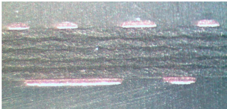
Рисунок 1 – Поперечное сечение печатной платы
