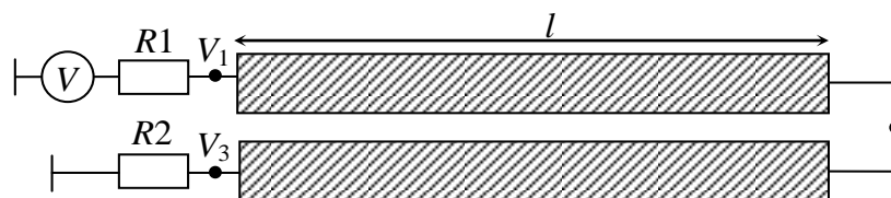
Рис. 4. Схема соединений витка МЛ
