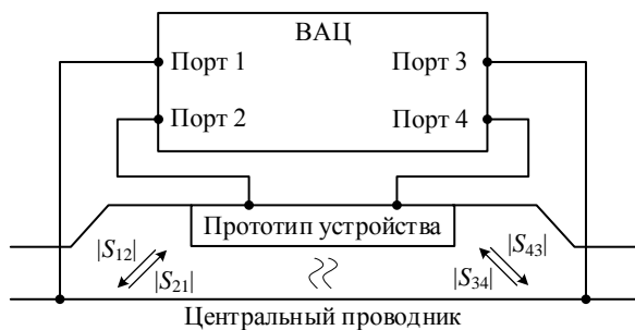
Рис. 11. Схема экспериментальной установки измерений в ТЕМ-камере для оценки излучаемых помехоэмиссий
