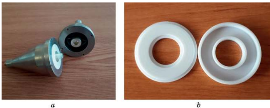
Рис. 1. Коаксиальная камера (а) с размещенным внутри контейнером (б)
