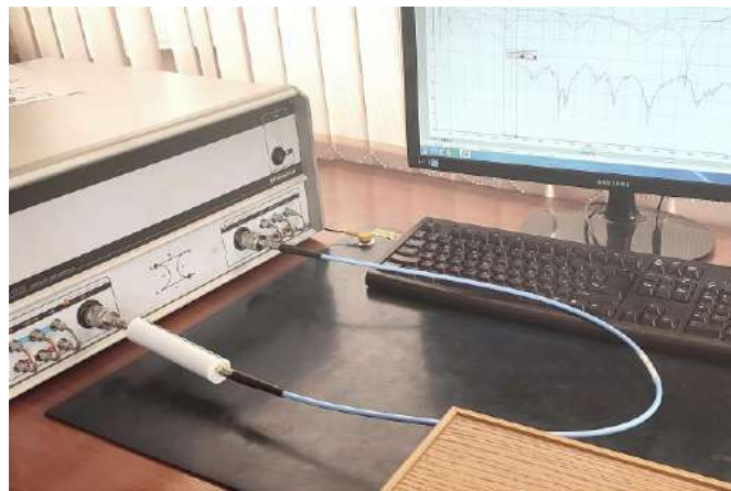
Рис. 13. Измерение частотных характеристик МФ без печатных плат с помощью «Панорама» P4226
