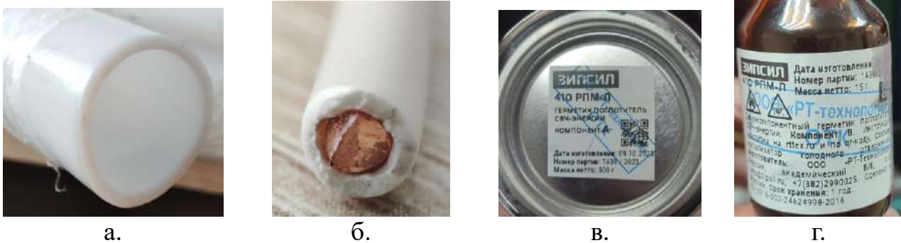
Рис. 5. Трубка фторопластовая (а), провод ПВ-1 (б) и РПМ (в, г)
