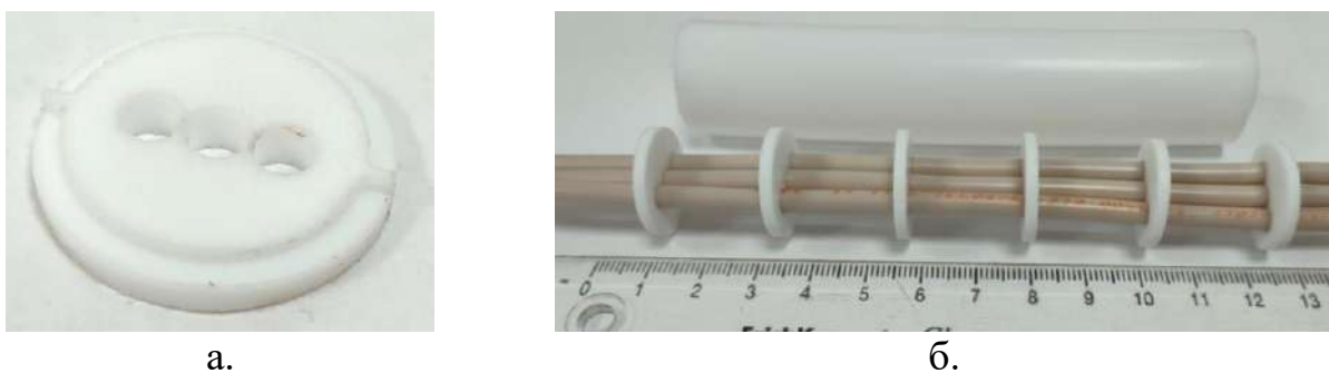
Рис. 6. Фторопластовая пластина для крепления проводов (а) и закрепленные провода (б)
