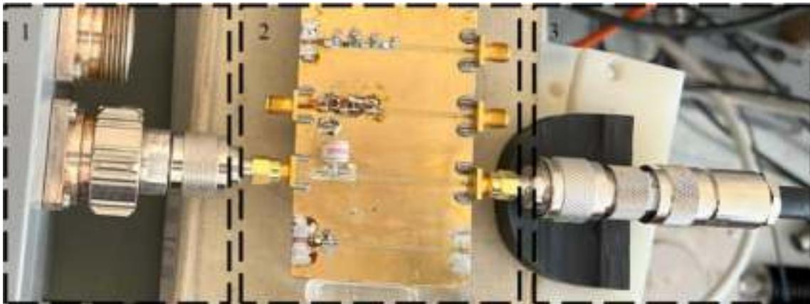
Рис. 11. Экспериментальная установка, где 1 – генератор, 2 – линия передачи с газоразрядным устройством, 3 – выход на аттенюатор и осциллограф Agilent DSO9254A
