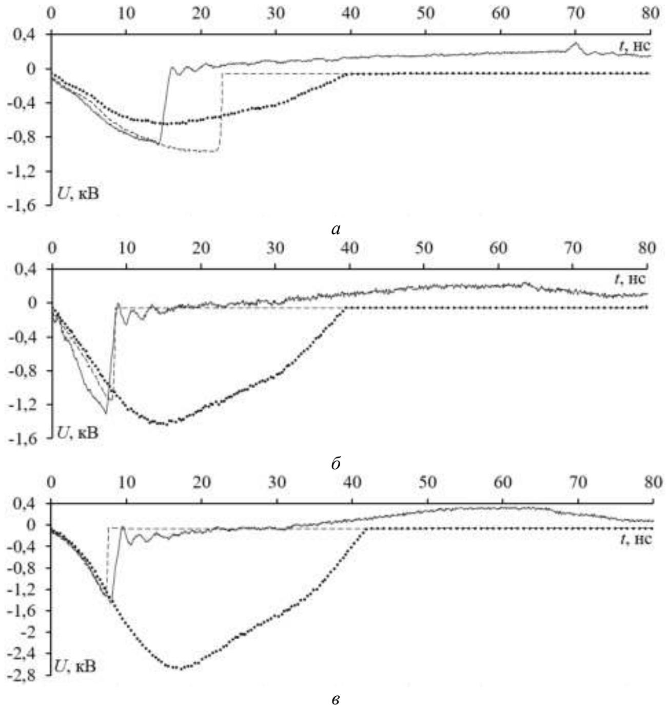
Рис. 13. Отклик газоразрядного устройства EC75X, полученный экспериментально (—), на основе исходной ( $\cdot \cdot$ ) и новой SPICE модели (— —) на воздействия с амплитудами напряжения 1 (а), 2 (б) и 4 (в) кВ
