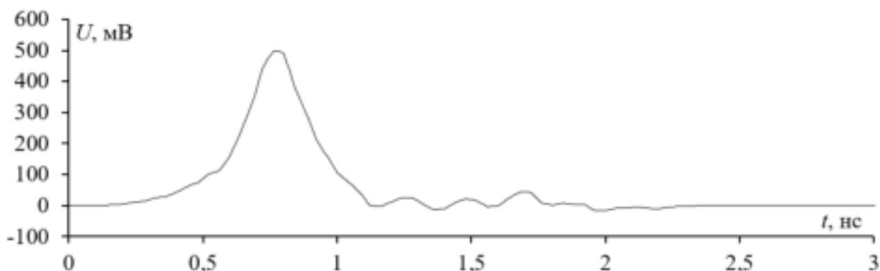
Рис. 4. Оцифрованный импульс с выхода генератора С9-11
